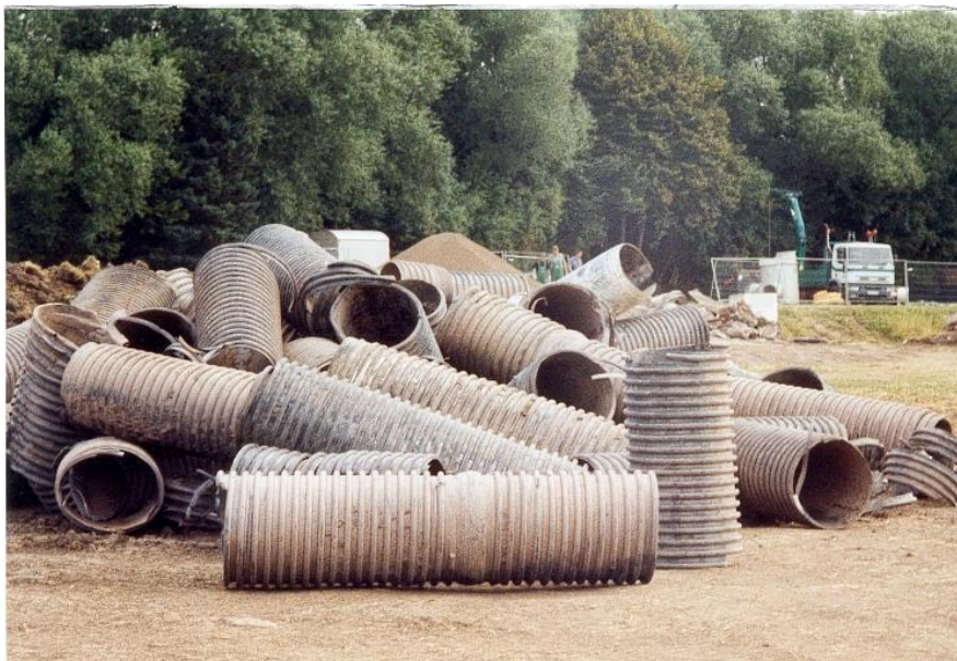
Foto Nr. 2 : - ausgebaute PE-Wickelrohre
